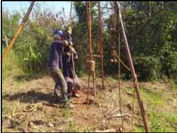
Execução de sondagem SPT
