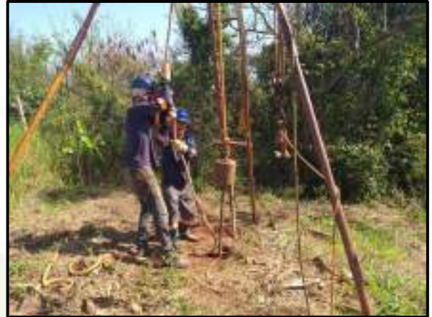
Execução de sondagem SPT
