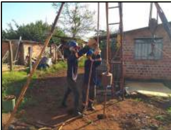
Execução de sondagem SPT
